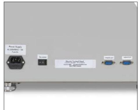
Interfaz para la transmisión de datos del instrumento de medición SAUTER FH y para controlar el banco de pruebas con el software SAUTER AFH
