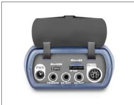
... y transmisión de datos mediante tarjeta de memoria MicroSD (4G) (incluida en el volumen de entrega), RS-232 o USB
