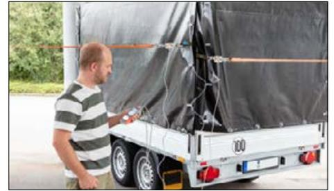
Posibilidad de medir fuerzas en diferentes direcciones de tracción o compresión con un solo instrumento de medición
