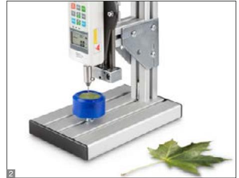
Banco de pruebas manual para mediciones precisas de la fuerza en tracción y en compresión de presión en un margen hasta 100 N
