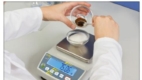
Con ayuda de la **función de formulación** es posible pesar los diversos componentes de una mezcla. Como medida de control se puede indicar el peso total de todos los componentes
